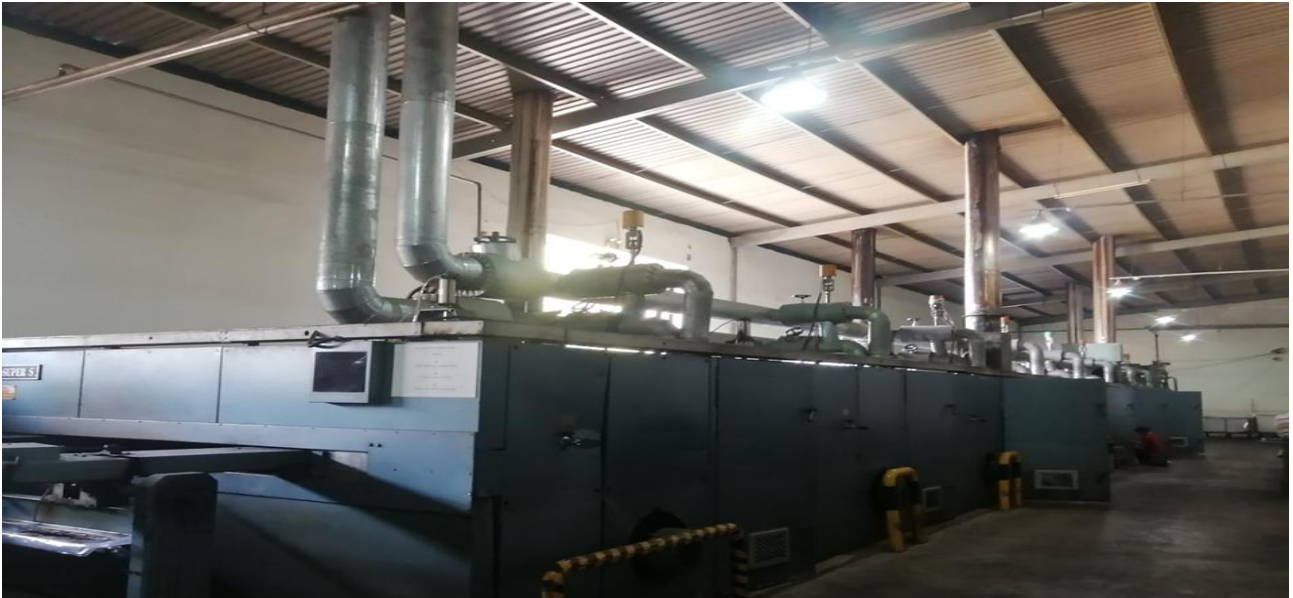
Hình 3.14. Máy sấy Tenter (hình ảnh thực tế)
